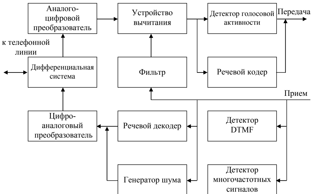
Рис. 2.1 — Структурная схема голосового шлюза
