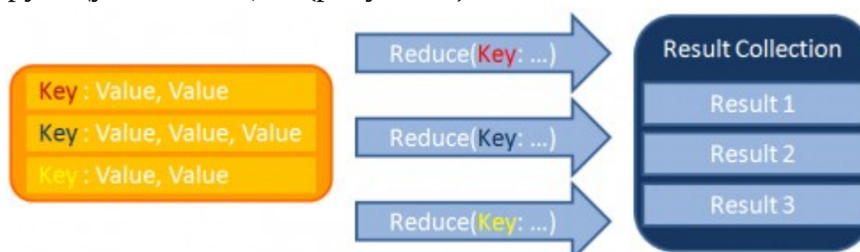
Рисунок 3 – Принцип работы Reduce
