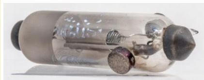
Рис. 13. Применение динатронной схемы в сверхрегенеративном приемнике. Общий вид лампового триод-детектора M-OV QX (1920 г.)
