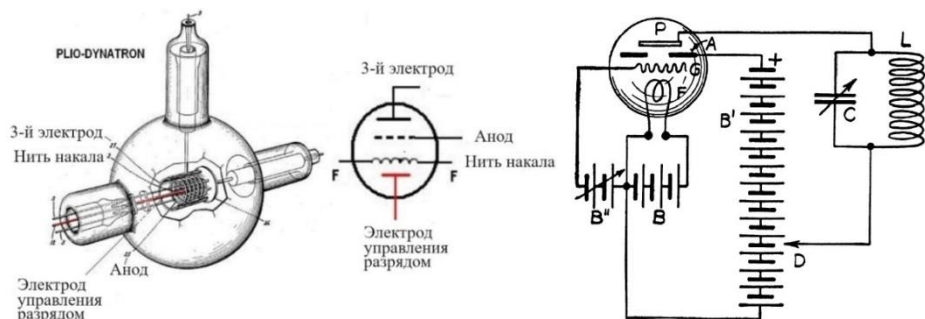
Рис. 10. Устройство плиодинатрона согласно патенту А. Халла US1385873A приоритетом от 5 июня 1916 г. Условно-графическое обозначение плиодинатрона на схемах. Схема включения плиодинатрона в качестве генератора электрических колебаний.
