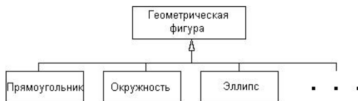
Рисунок 8 - Пример графического изображения отношения обобщения классов
