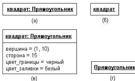
Рисунок 12 - Пример графического изображения объектов на диаграммах языка UML
