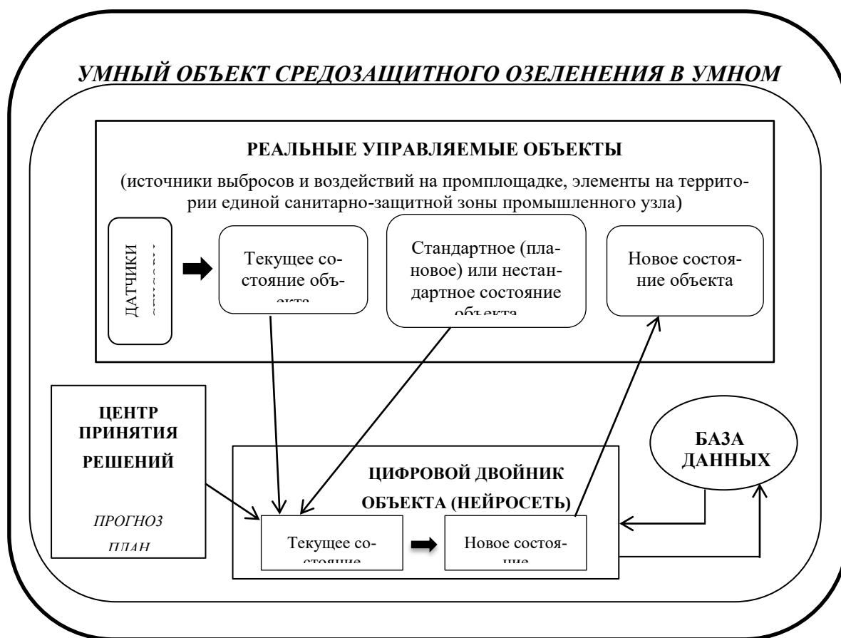
Рис 2. Принцип работы сервиса «Чистый воздух промзоны»
