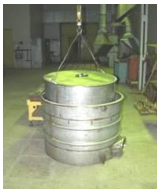
Рис. 3.28. Адсорбер угольный АУ-1500 ВМ: 1 – адсорбент, 2 – входной патрубок; 3 – верхняя решетка; 4 – корпус; 5 – выходной патрубок; 6 – нижняя решетка
