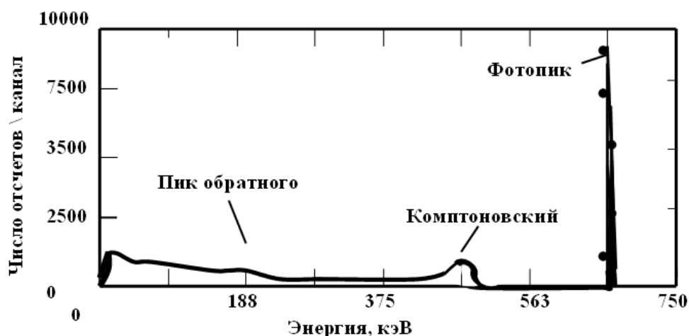
Рис. 1.10. Спектр высокого разрешения ^{137}\text{Cs} , на котором показаны пик полного поглощения (фотопик), комптоновский край и пик обратного рассеяния для гамма-кванта с энергией 662 кэВ. События ниже фотопика обусловлены комптоновским рассеянием в детекторе и окружающих его материалах
