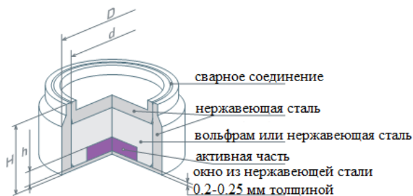
Рис. 2.51. Дисковый источник, окно из нержавеющей стали
