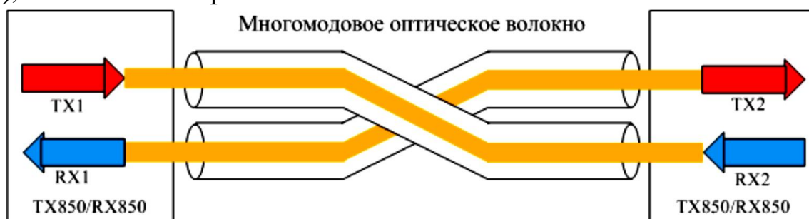
Рис. 1.4 — Принцип действия многомодового SFP -модуля
