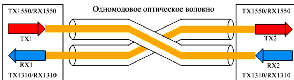
Рис. 1.5 — Принцип действия одномодового SFP модуля
