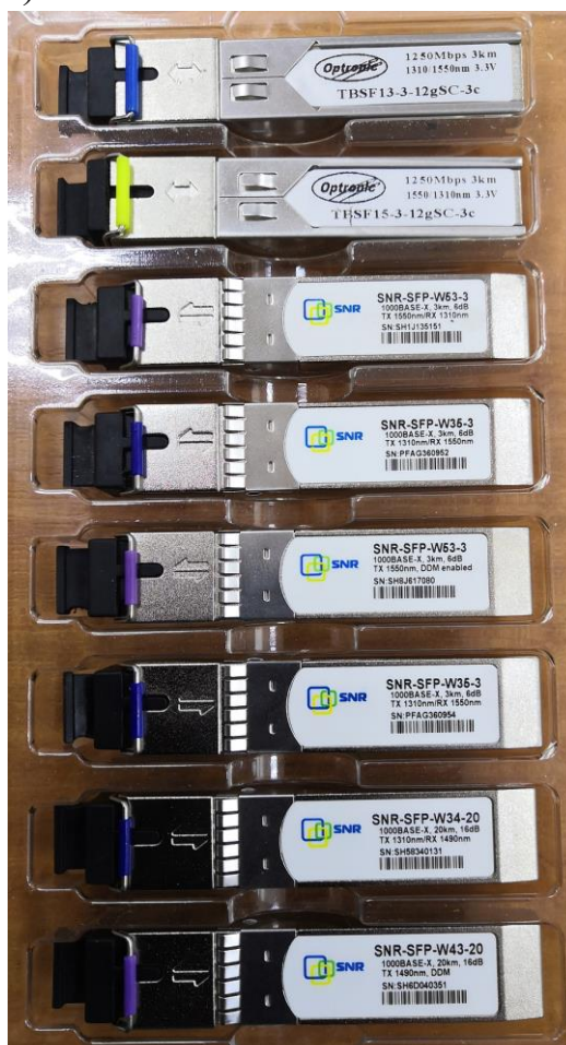
Рис. 1.6 — SFP-модули двухволоконные (а) и одноволоконные (б)
