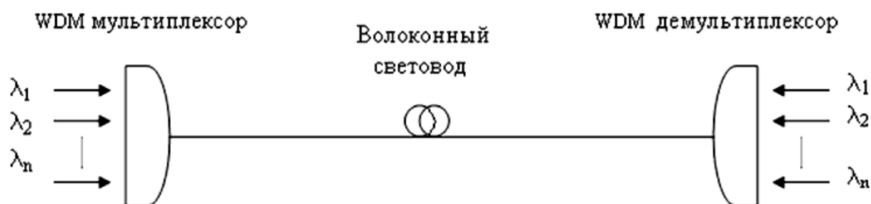
Рис. 2.2 — Схема оптического сегмента, использующего передачу мультиплексного сигнала по волоконному световоду
