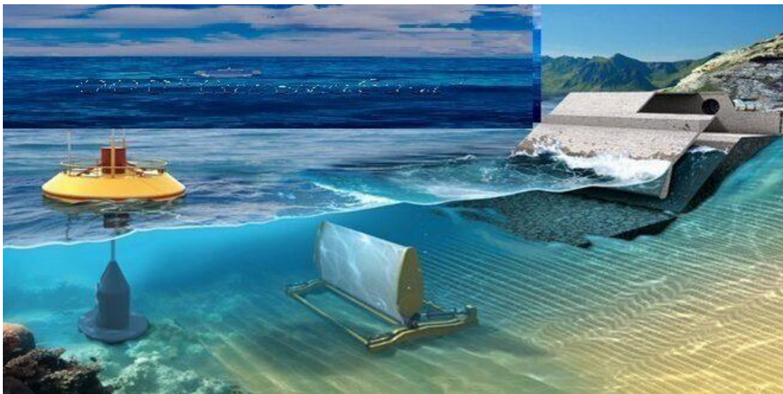
Рисунок 5.4 - Волновая электростанция. Поплавок, маятник, волноприёмник
