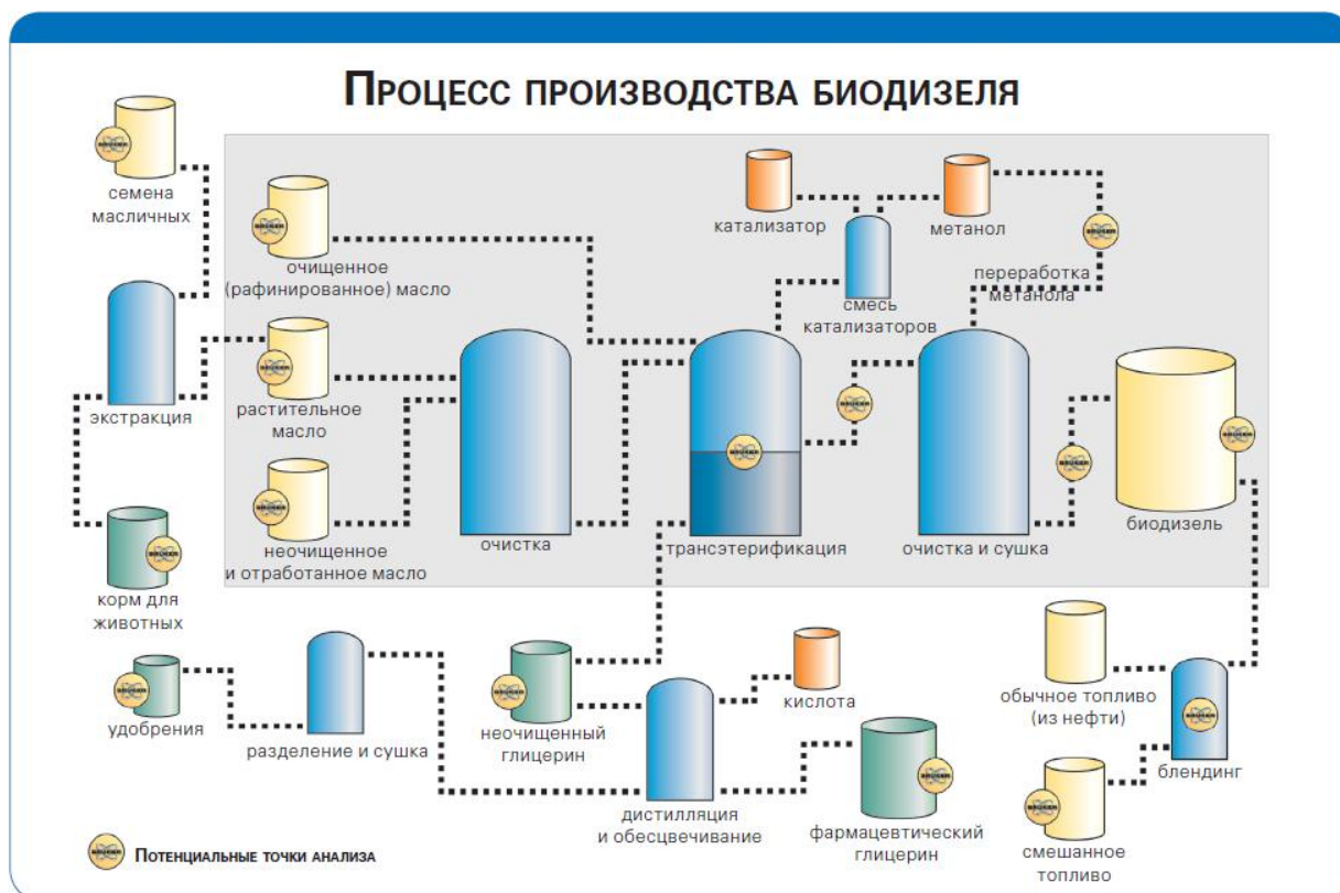
Рисунок 6.2 – Схема производства биодизеля
