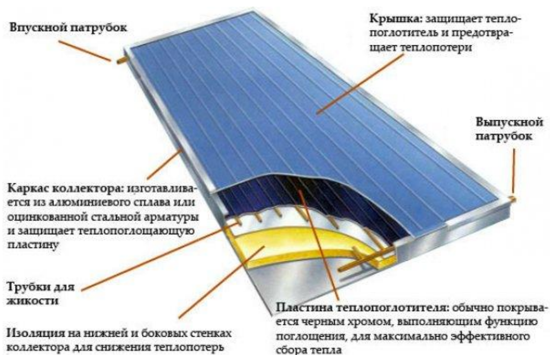
Рисунок 2.5 – Устройство солнечного коллектора
