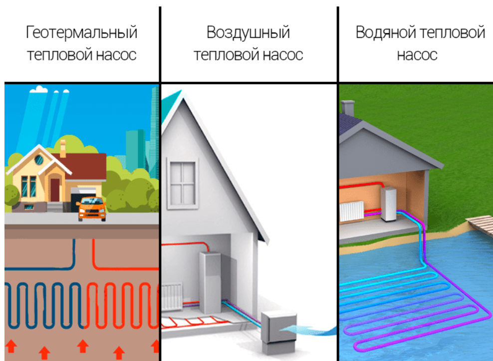
Рисунок 4.9 – Схемы геотермального, воздушного и водного тепловых насосов
