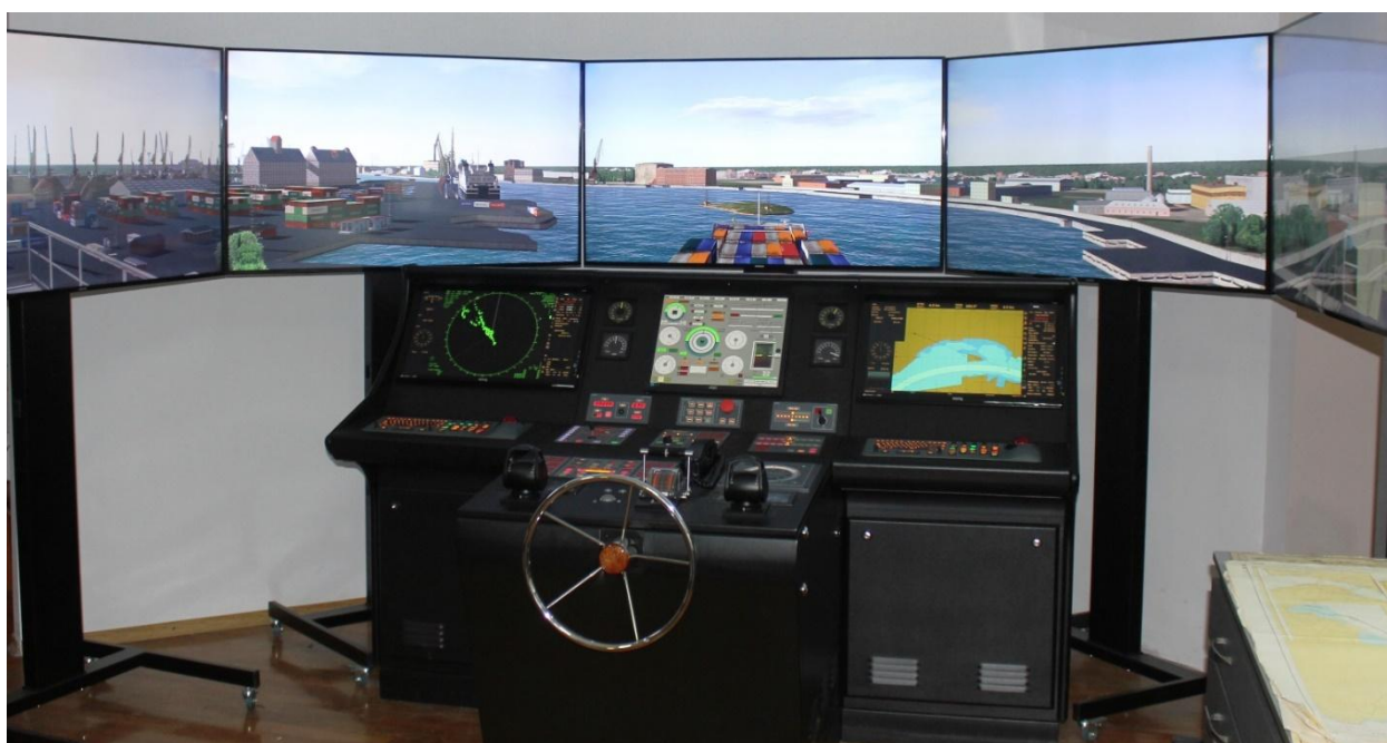
Рисунок 1 – Главный мостик тренажерного комплекса
