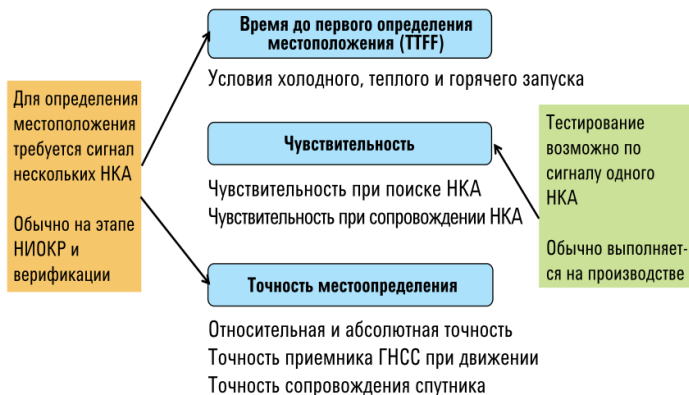
Рис. 2. Наиболее характерные тесты приемника ГНСС
