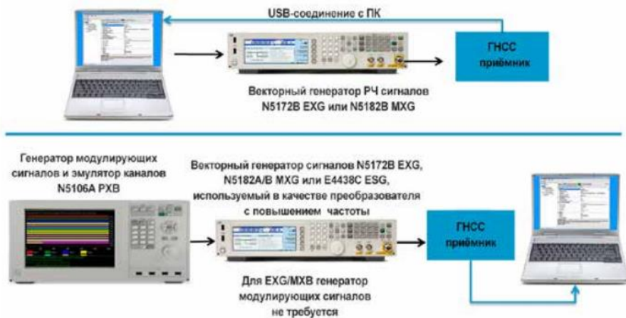
Рис. 3. Использование ПО N7609B Signal Studio для тестирования приемников ГНСС
