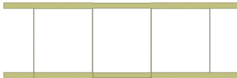
Рис. 2. Стандартная конструкция четырехшлейфного моста
