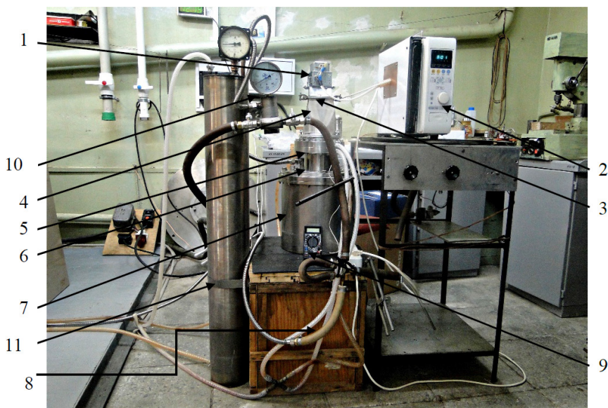
Рис. 1 Фотография установки для исследования СВЧ-пиролиза торфа: 1 - промышленный 2.46 ГГц / 1 кВт магнетрон; 2 - система сетевого питания; 3 - система воздушного охлаждения магнетрона; 4 - согласующие волноводные элементы; 5 - барьерное окно; 6 - волновод связи; 7 - рабочая камера реактора; 8 - система водяного охлаждения реактора; 9 - термопара; 10 - манометр; 11 - теплообменник для охлаждения выходных газов из реактора.
