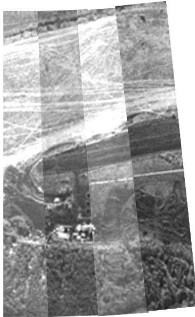
Рис. 1. Влияние ошибок измерения радиальной скорости при совмещении парциальных кадров радиолокационного изображения большого размера Fig. 1. The effect of the errors in radial speed measurement when the partial frames of a large radar image are merged
