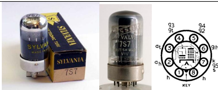
Рис. 8. Триод-гептод 7S7 производства Sylvania (1941 г.) и Cossor (1948 г.).
