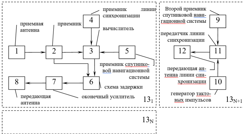
Рис. 1. Структурная схема системы постановки помех мобильным системам радиосвязи со СШП сигналами.
