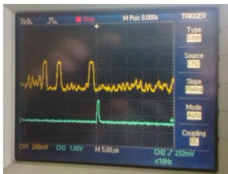
Верхний луч - сигнал ЗД на выходе детектора приёмника; Нижний луч – импульс декодирования кодовой группы ЗД
