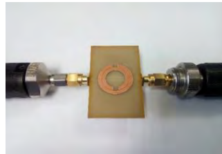
Рис. 8 – Макет одноэлементной структуры разрезного резонатора для экспериментальной проверки результата моделирования
