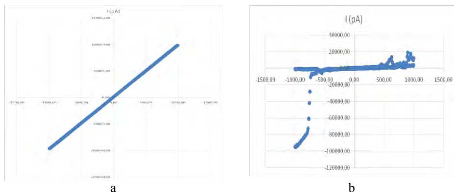
Рис. 2. а – ВАХ одиночного провода с контактом к подложке, б – ВАХ одиночного провода без контакта с подложкой
