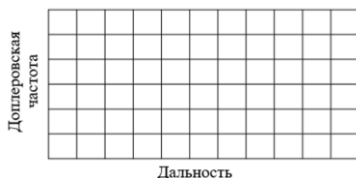
Рис. 2. Разделение поверхности по частоте и дальности.
