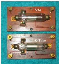
Рис. 4. Детекторный приемник с усилителем на лампах типа V24 и варианты их крепления.
