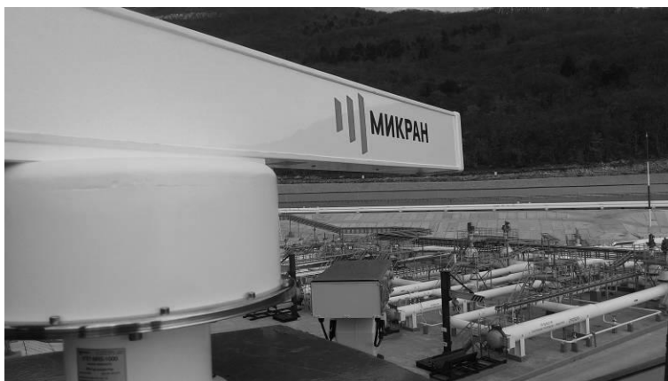
Рис. 6. Антенный сенсор РЛС MRS-1000 на мониторинге объекта
