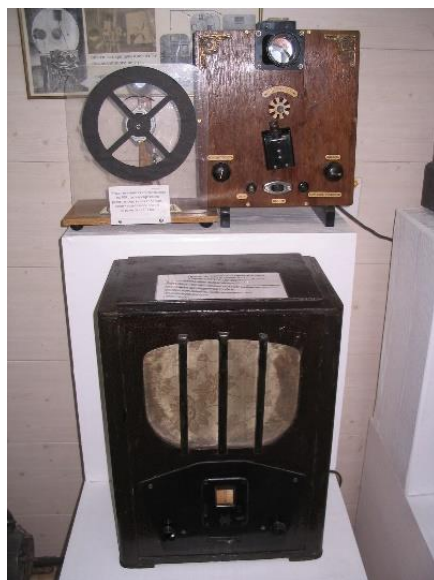
Рис. 4. Приемник звукового сопровождения к механическому телевизору.
