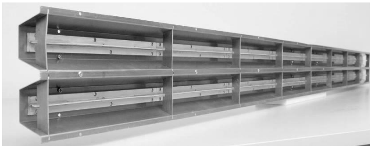
Рис. 2. Внешний вид приёмно-передающей антенны навигационной РЛС «Река». Средняя частота диапазона 9432 МГц, ширина полосы пропускания не уже 200 МГц, ширина главного лепестка диаграммы направленности 2 \times 25^\circ , коэффициент усиления 26 дБ, уровень первого бокового лепестка минус 26 дБ
