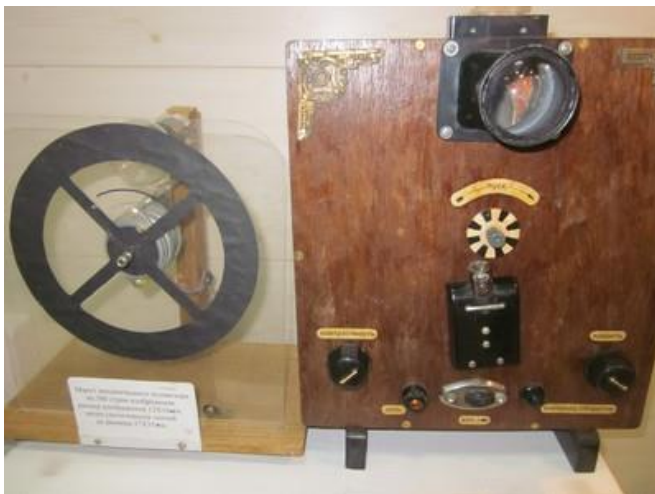
Рис. 3. Телевизор с механической разверткой на 30 строк, размер экрана 12 \times 16 мм (с линзой 27 \times 35 мм), 1936 г.
