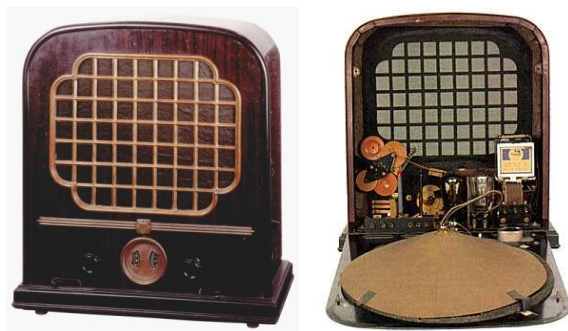
Рис. 7. Внешний вид радиоприемника «Telefunken 12» и его внутреннее устройство. Изготовитель Telefunken Austria. 1930 г. [8].
