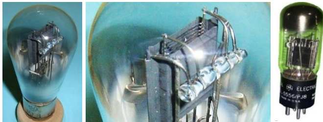
Рис. 14. Общий вид плиотрона GERJ-8 и его устройство.
