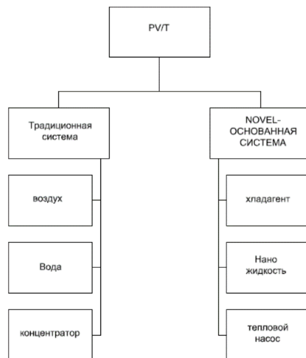
Рис. 1. Схема традиционных и альтернативных типов охлаждения термофотоэлектрических систем (PV/T)
