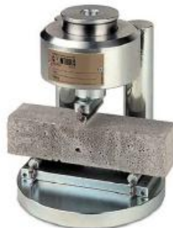
Рисунок 14 – Устройство для испытания образцов-призм на изгиб
