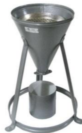
Рисунок 16 – Воронка для определения насыпной плотности порошкообразных материалов
