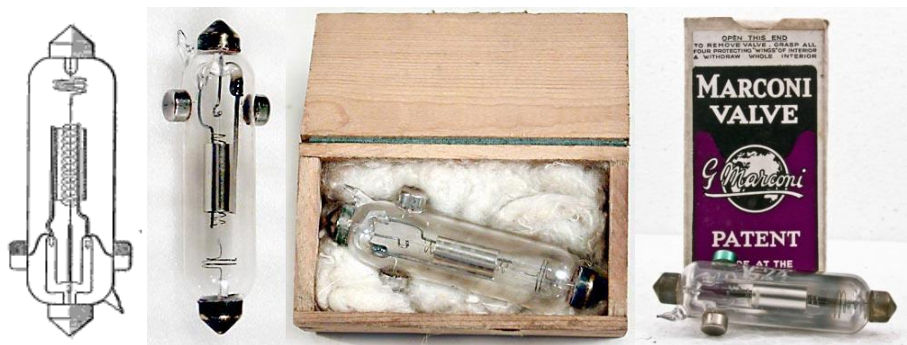
Рис. 13. Устройство радиолампы Раунда типа V24 и ее промышленные образцы с упаковочными коробками для продажи. 1916-1917 гг.
