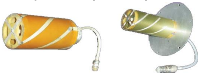
Рис. 1. Конструкции печатных спиральных бортовых антенн дециметрового диапазона систем ГЛОНАСС.
