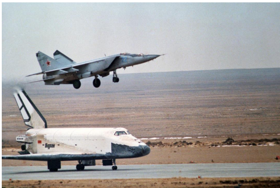
Рис. 7. Посадка Бурана с помощью 2-см микроволновой системы посадки «Вымпел-Б» в автоматическом режиме 15 ноября 1988 г.
