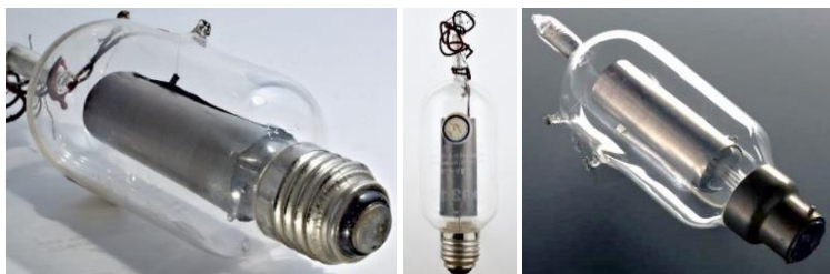
Рис. 8. Радиолампа Раунда типа N : общий вид, цоколь винтовой Edison и цоколь байонетный Ediswan . 1914-1915 гг.
