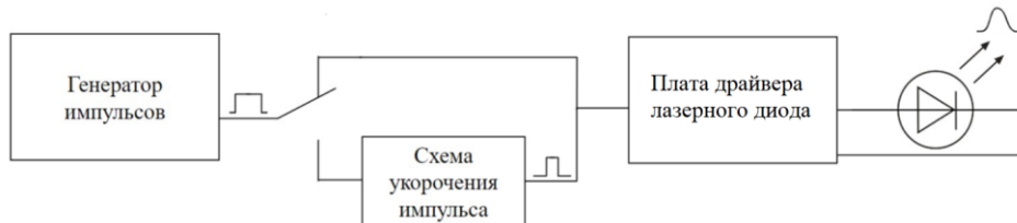
Рис. 3. Блок-схема модели драйвера ЛД.
