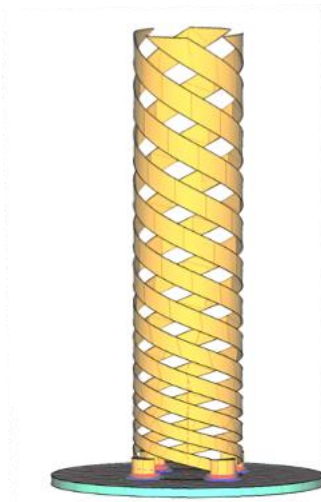
Рис. 14. Упрощённая оптимизированная модель четырехзаходной четырехзаходной нерегулярной цилиндрической спиральной антенны в САПР FEKO без учета каркаса (а) с учётом диэлектрического несущего цилиндрического каркаса (б).
