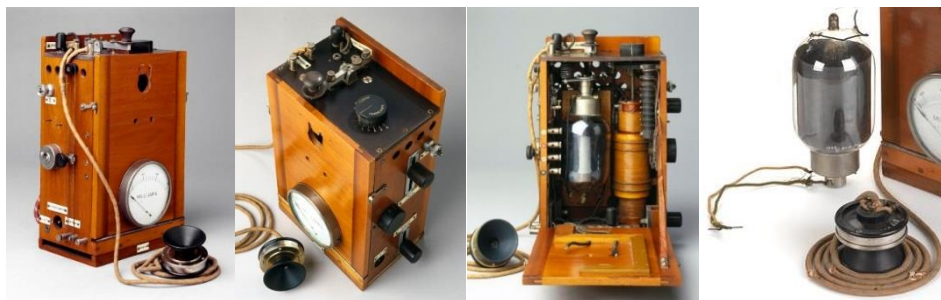
Рис. 7. Общий вид авиационного радиотелефонного передатчика на передающей лампе Раунда типа T31. Триод T31 и микрофон передатчика. 1915 г.
