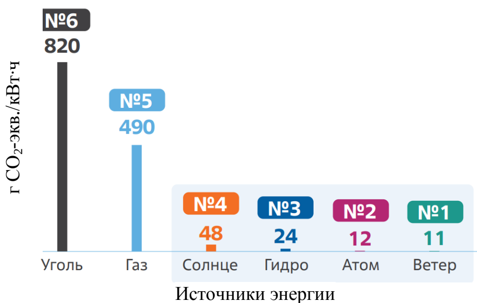
Рис. 2.6. Выбросы парниковых газов на жизненном цикле электростанции (по данным МГЭИК)
