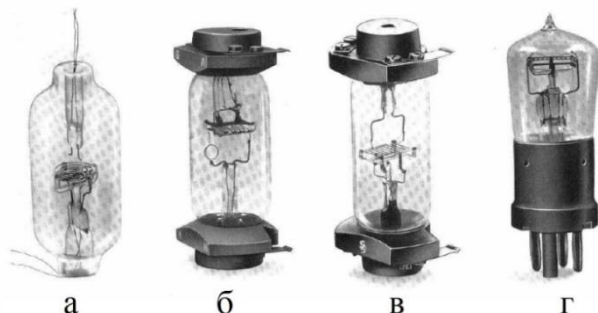
Рис. 6. Лампа типа A Siemens & Halske : а — первый вариант (1916 г.), б — вариант с прямоугольной проволочной сеткой (1916 г.), в — вариант со штампованной сеткой (1917 г.), г — вариант с цоколем (1918 г.).
