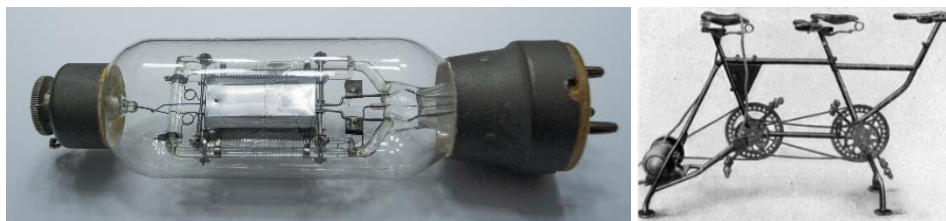
Рис. 5. Общий вид триода RS5. Педальная рамка для управления малой радиостанцией G-Fuk 16a (1917 г.).
