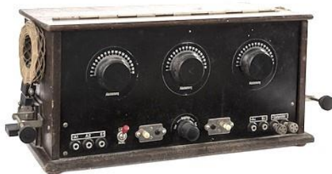
Рис. 22. Принципиальная схема радиоприемника Loewe Type 2H3N для дальнего приема на многократных лампах 2HF и 3NF. Общий вид приемника Loewe Type 2H3N . 1928 г.
