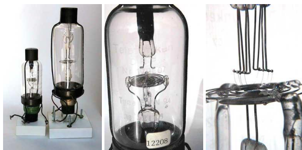
Рис. 4. Сравнение ламп EVN94 (слева) и EVS129 (1915 г.). Общий вид 4 нитей накала лампы EVS129 .
