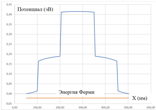
Рис. 5. Потенциальный рельеф для электронов в структуре, показанной на рис. 4, при: L_z = 20 \text{ нм} , L_{y1} = L_{y3} = 20 \text{ нм} , L_{y2} = 10 \text{ нм} , L_{x1} = L_{x3} = 100 \text{ нм} , L_{x2} = 150 \text{ нм} .
