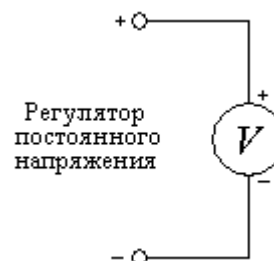
Рис. 2. Режим холостого хода источника энергии
