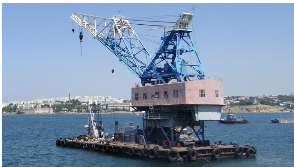
Рис. 9.2. Плавкран пр. 771 с краном г/п 50 т
