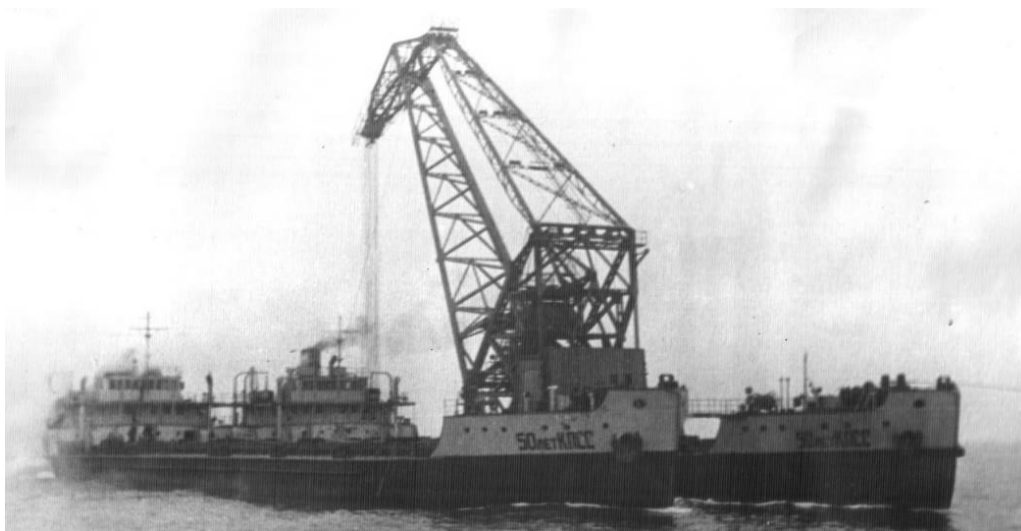
Рис. 9.1. Крановое судно «50 лет КПСС» с краном г/п 100 т
