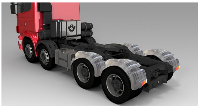
Рис. 1. Прототип детали для грузовика Scania © iemai3d.com Оборудование: FGF-принтер IEMAI FAST JET 1500 Материал: модифицированный PETG. Размер модели: 1315 x 540 x 670 мм. Время печати: 30 часов
