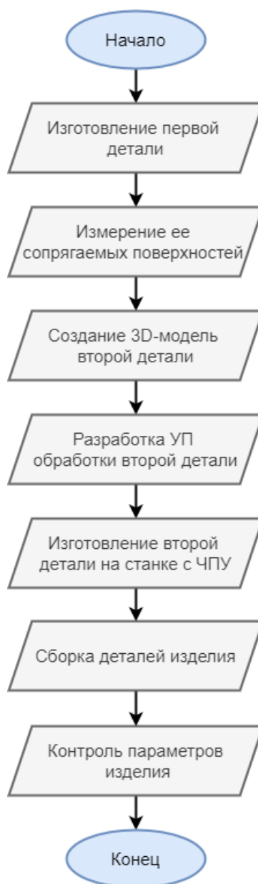
Рис. 1. Блок-схема алгоритма основных вычислительных процедур предлагаемого способа изготовления сборного изделия
