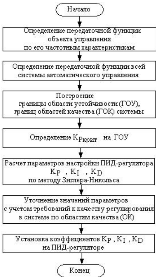
Рисунок 1 – Блок–схема метода настройки параметров ПИД-регуляторов
