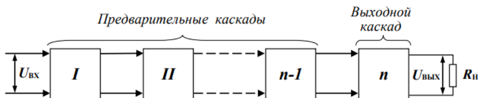
Рис. 1. Структурная схема многокаскадного усилителя
