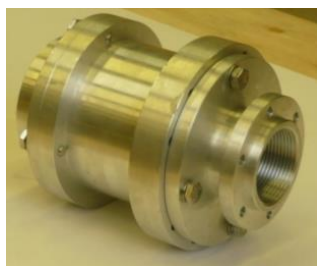
Рис. 6. Вращающееся сочленение, работающее в диапазоне частот 26—32 ГГц.
