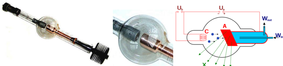
Рис. 9. Общий вид лампы Кулиджа и ее схема включения.
