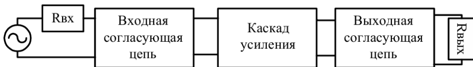
Рис. 2. Принципиальная схема усилителя мощности.
