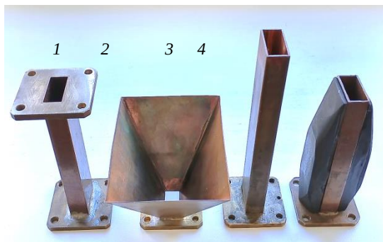
Рис. 1. Внешний вид эталонных антенн (1, 2) и исследуемых антенн (3, 4).
