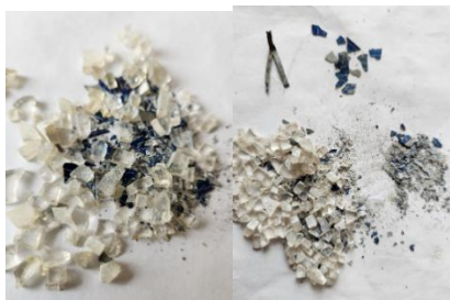
Рис. 3. Термическая обработка фрагмента фотоэлектрического модуля в муфельной печи
