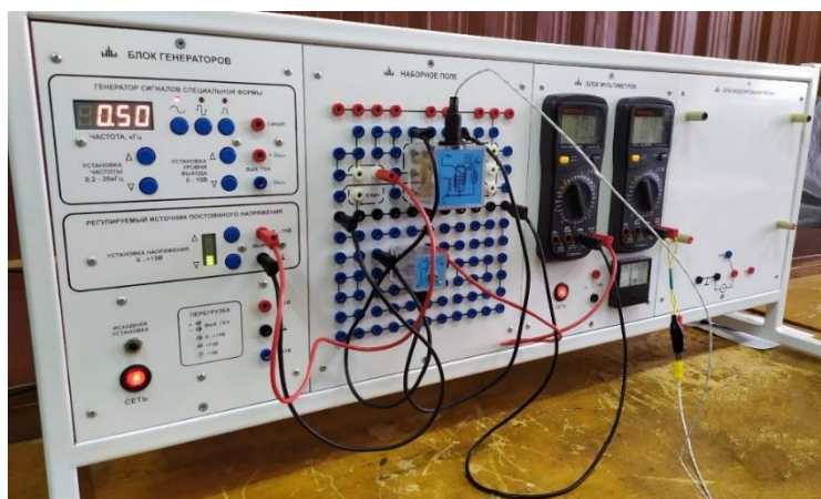
Рис. 2. Схема новой установки с электрическим нагревом, термопарой и цифровыми измерительными приборами.
