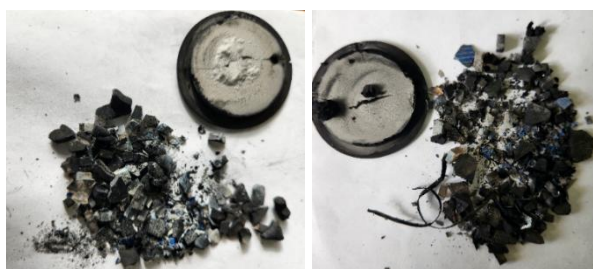
Рис. 4. Термическая обработка фрагмента фотоэлектрического модуля в электродуговом плазменном реакторе переменного тока
