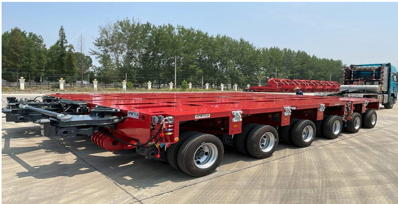
Рис. 3. Тяжелая платформа типа Goldhofer TNP/SL
