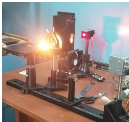
Рис. 4. Фотография экспериментальной установки с горящим ВЭМ
