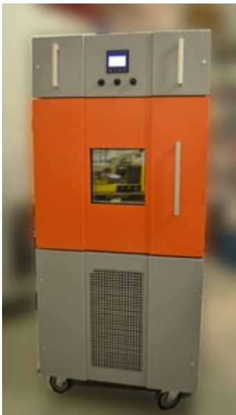
Рисунок 3.6 — испытательная камера "Тепло-Холод-Влага"
