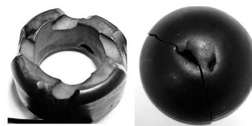
Рис. 4. Фото разрушенной форсунки конструкции ТКЗ «Красный котельщик»
