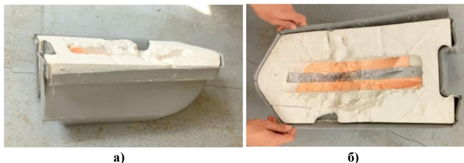
а) б) Рис. 5. Результат вакуумной формовки с использованием гипсовой матрицы. а) Форма из ABS пластика; б) Матрица из гипса
