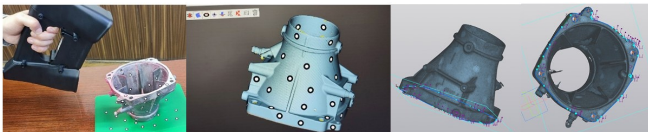
Рис.1. 3D сканирование спрямляющего устройства водометного движателя
