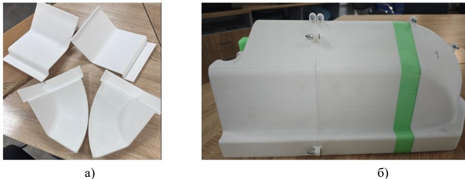
Рис. 3. Разборной форма для изготовления матрица вакуумной формовки из гипса. а) детали; б) форма в собранном виде
