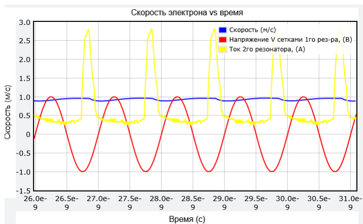
Рис. 3. Временные зависимости физических величин в модели клистрона.
