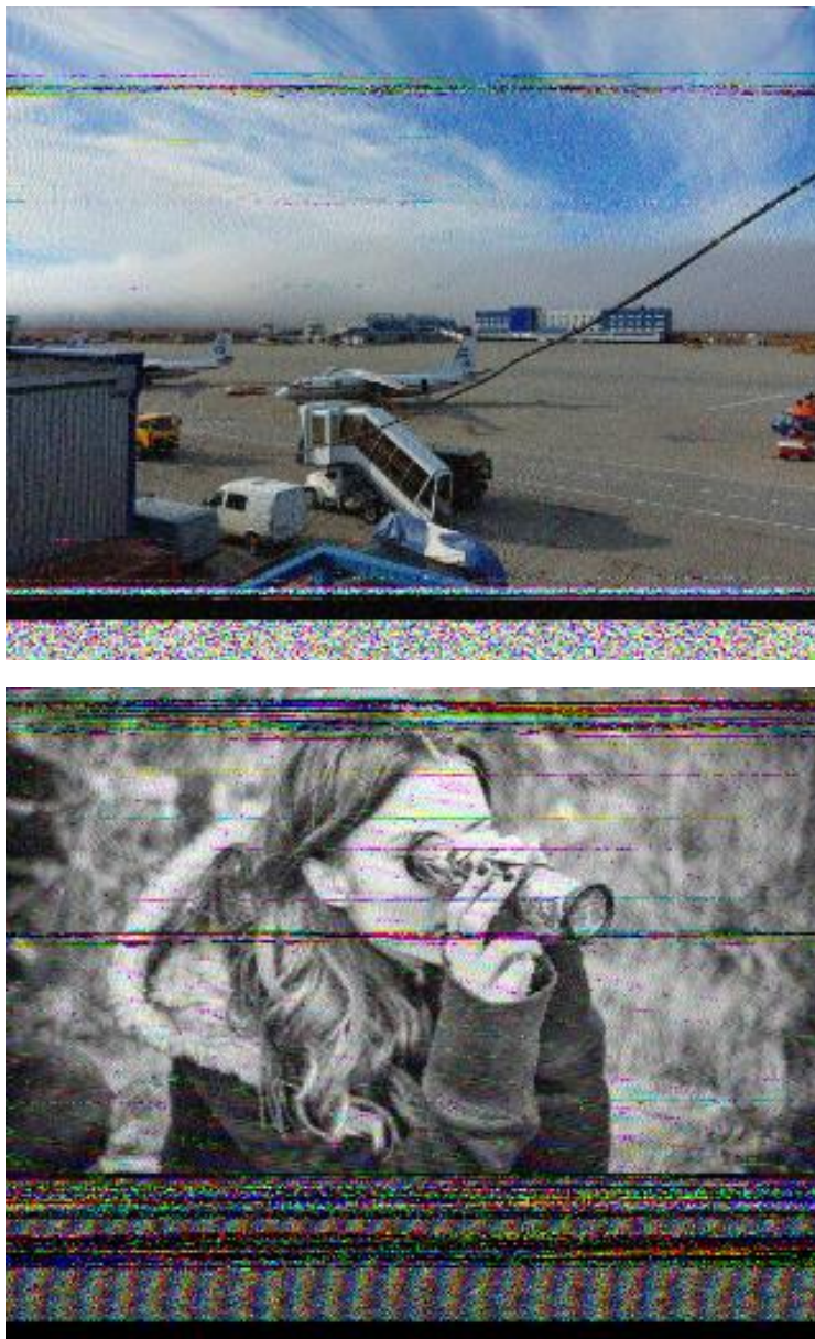
Рис. 12. Примеры изображения в условиях средневозмущенной ионосферы (наиболее часто встречающийся вариант в условиях высоких широт).
