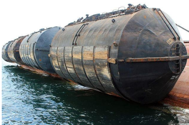
Рисунок 5.2.2.1. Понтоны стальные судоподъемные.
