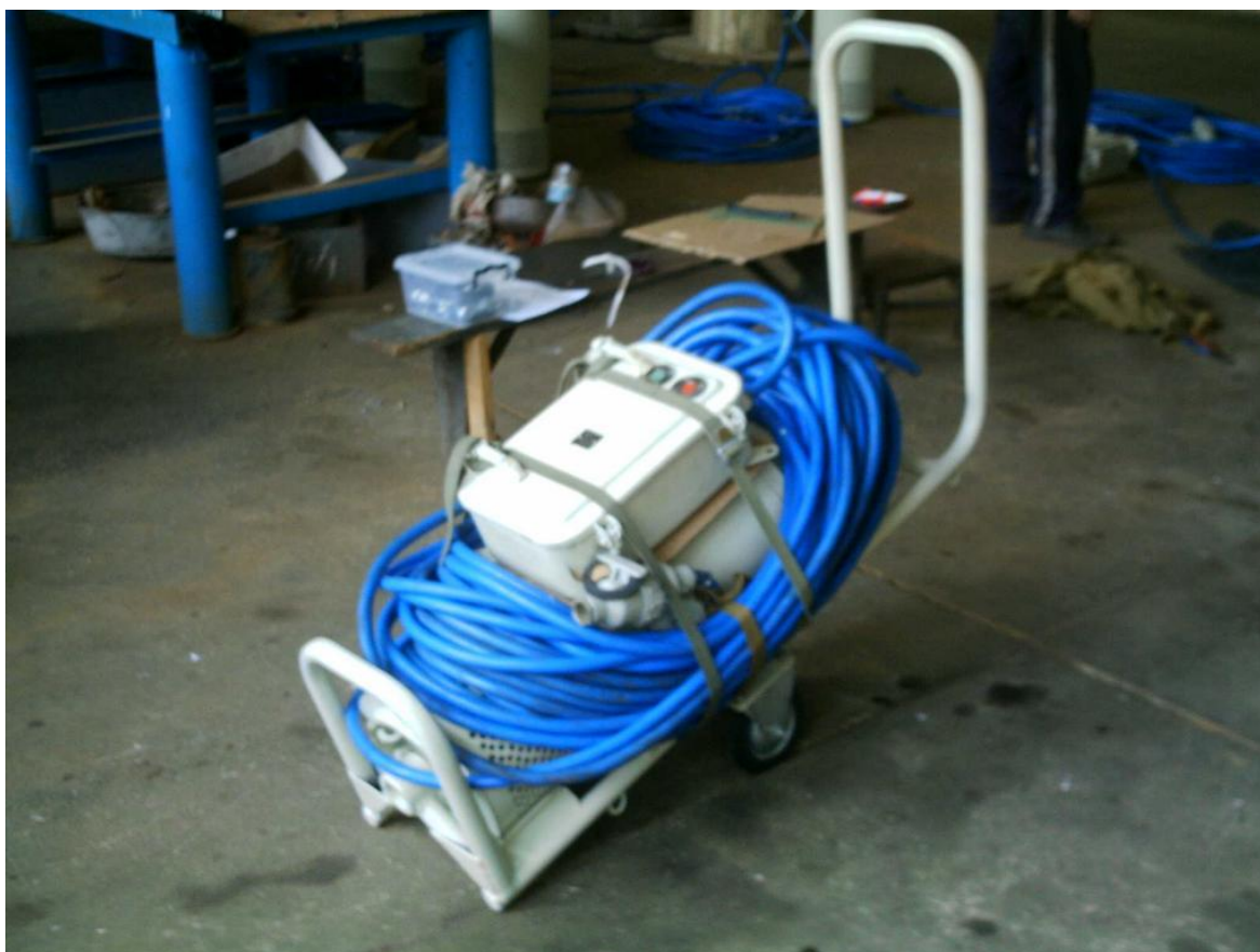
Рисунок 3.1.5.18. Водоотливной электронасос ВПЭН-100 с транспортной тележкой.
