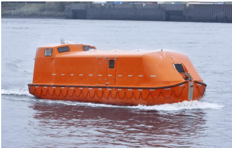
Рис. 3.1.4.10. Полностью закрытая спасательная шлюпка
