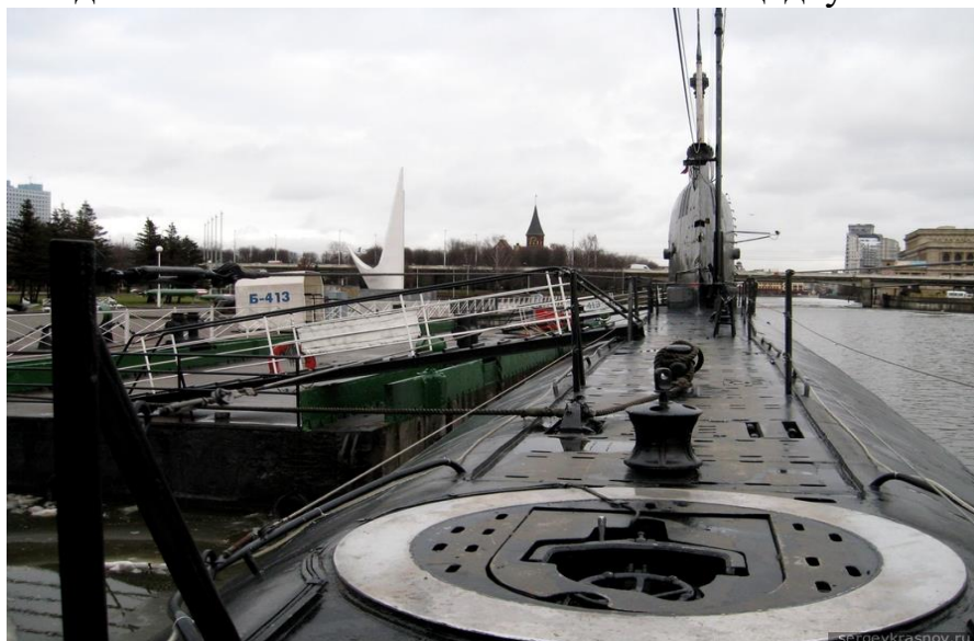
Рисунок 4.1.8.2. Аварийный люк с комингс-площадкой.
