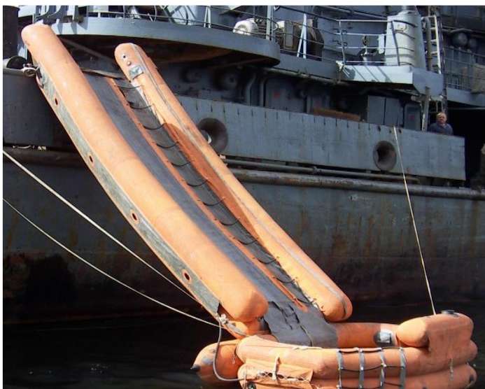
Рис. 3.1.1.12. Пневматическое посадочное устройство ППУ-5
