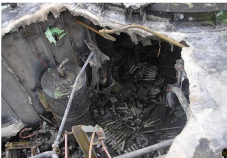
Рисунок 4.1.6.7. Последствия пожара в погребе боезапаса.
