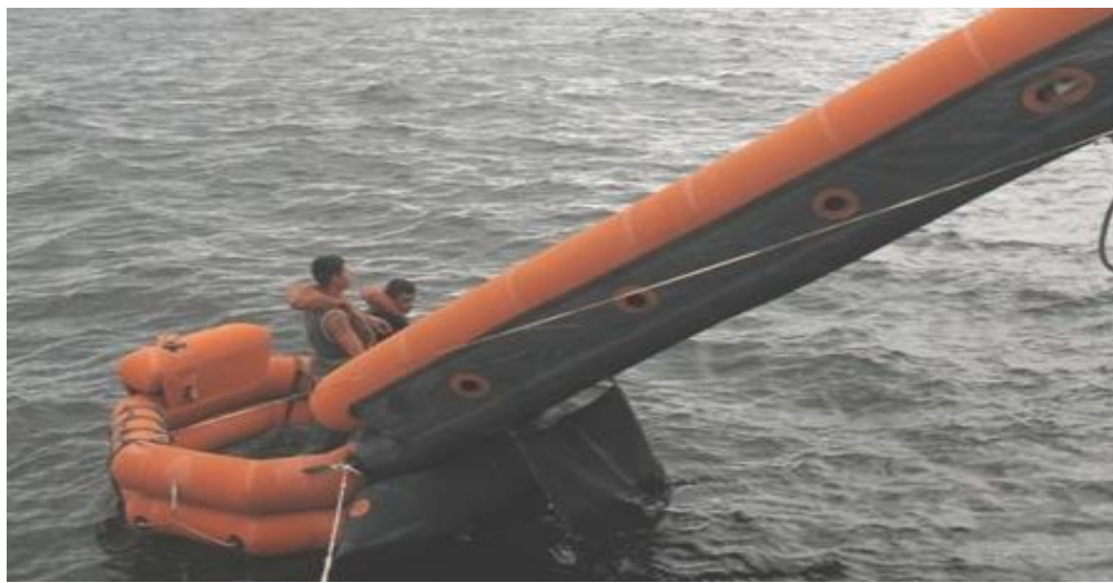
Рис. 3.1.4.18. Пневматическое посадочное устройство ППУ-5.
