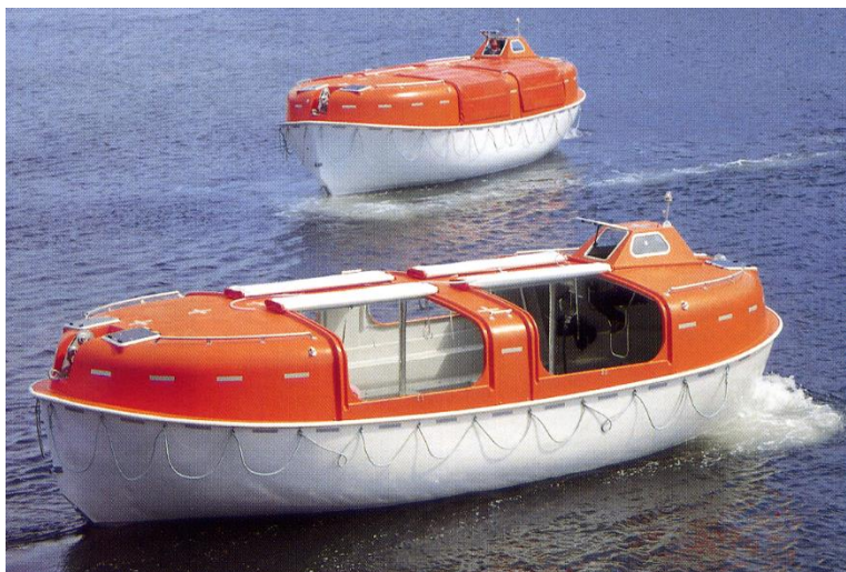
Рис. 3.1.4.9. Частично закрытая спасательная шлюпка
