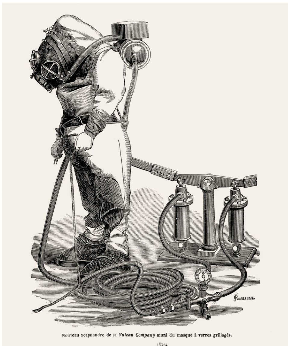
Рис. 1.1.1.23. Водолазное снаряжение Б.Рукейроля и О.Денейруза.
