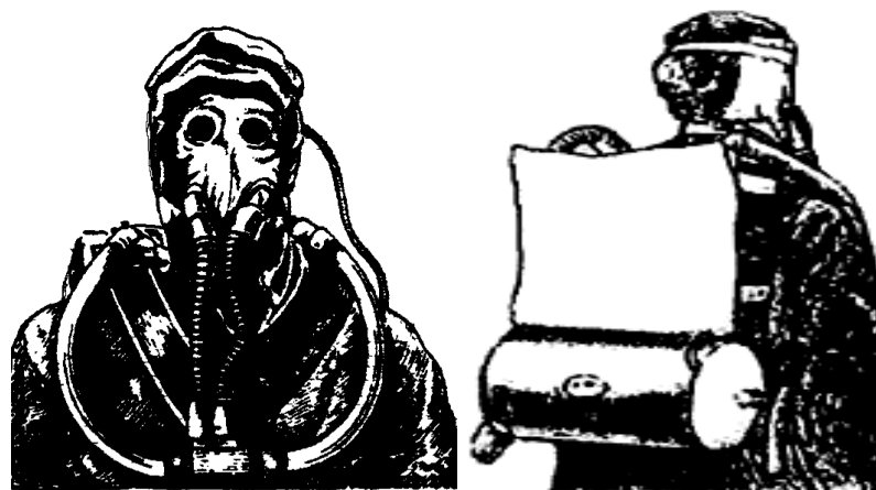
Рис. 1.1.1.26. Дыхательный аппарат Генри Флюса с замкнутым циклом.
