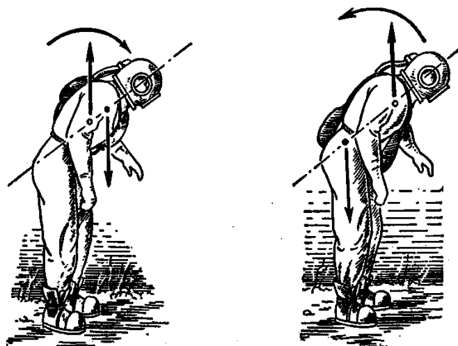
Рис. 1.1.1.40. Основные силы действующие на водолаза под водой: а) водолазные груза висят высоко; б) водолазные груза висят низко.
