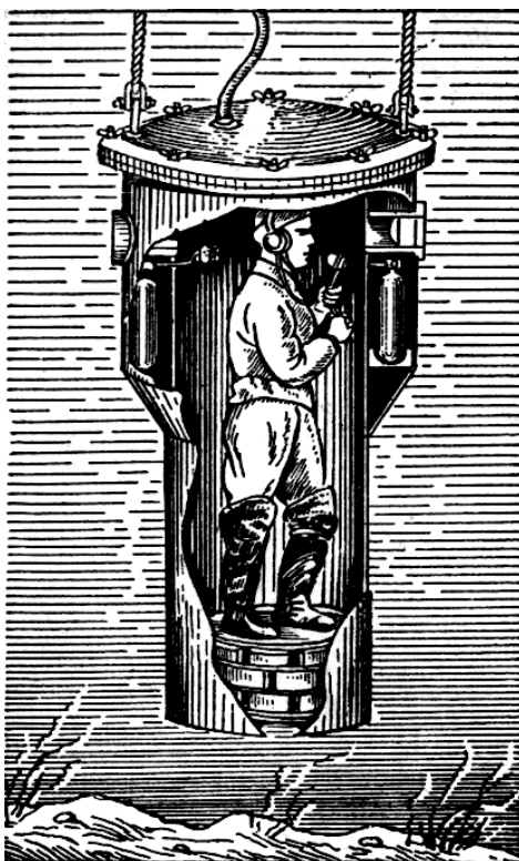
Рис. 1.1.1.29. Наблюдательная камера Роберта Девиса.
