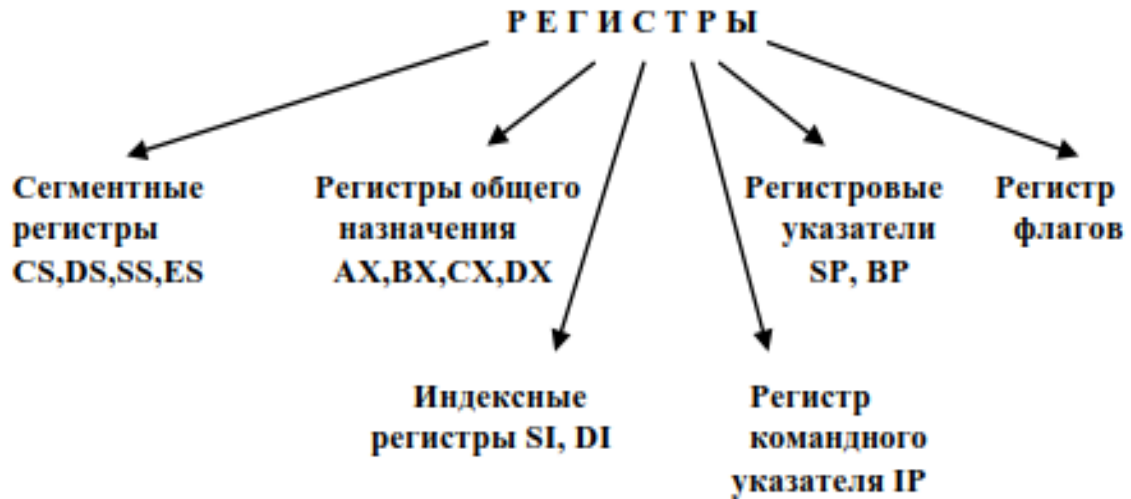
Рисунок 2 – Классификация регистров процессора i8086/8088
