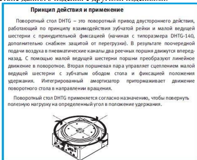
Рис. 8.14. Фрагмент описания принципа действия поворотного стола DHTG
