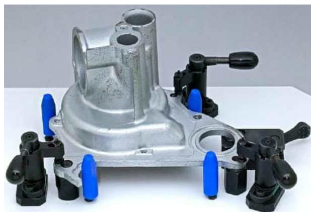
Рис. 4.6. Пример применения модульных зажимных элементов «ONE-TOUCH clamps»
