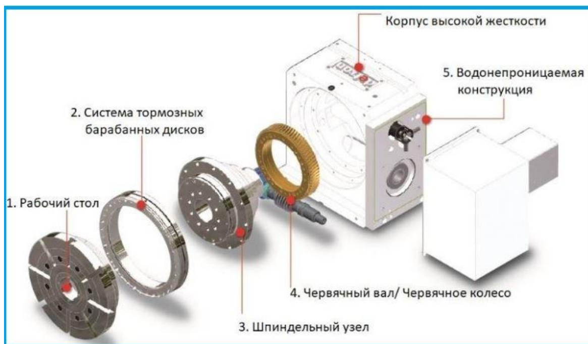
Рис 8.13. Пример схемы деления поворотного стола для станка с ЧПУ
