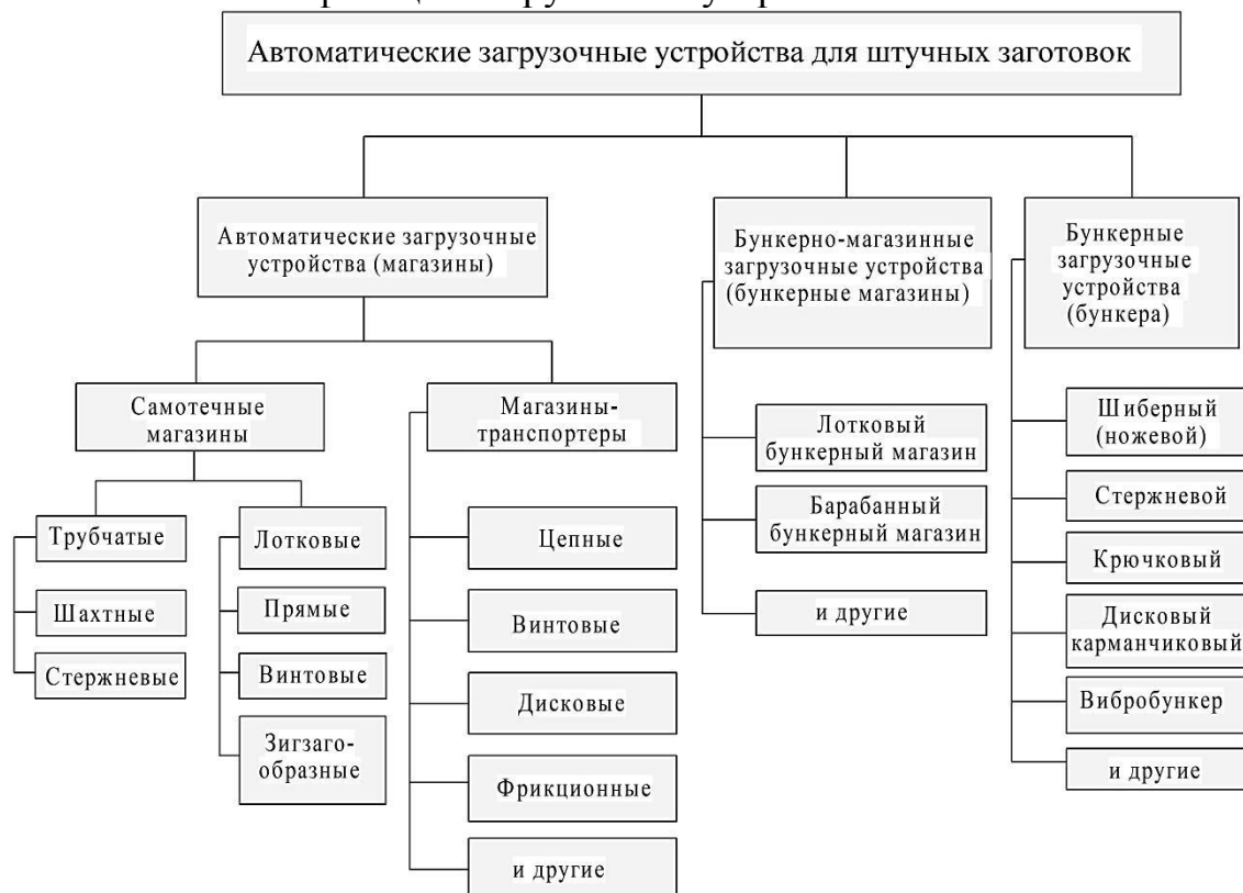
Рис. 5.1. Классификация загрузочных устройств
