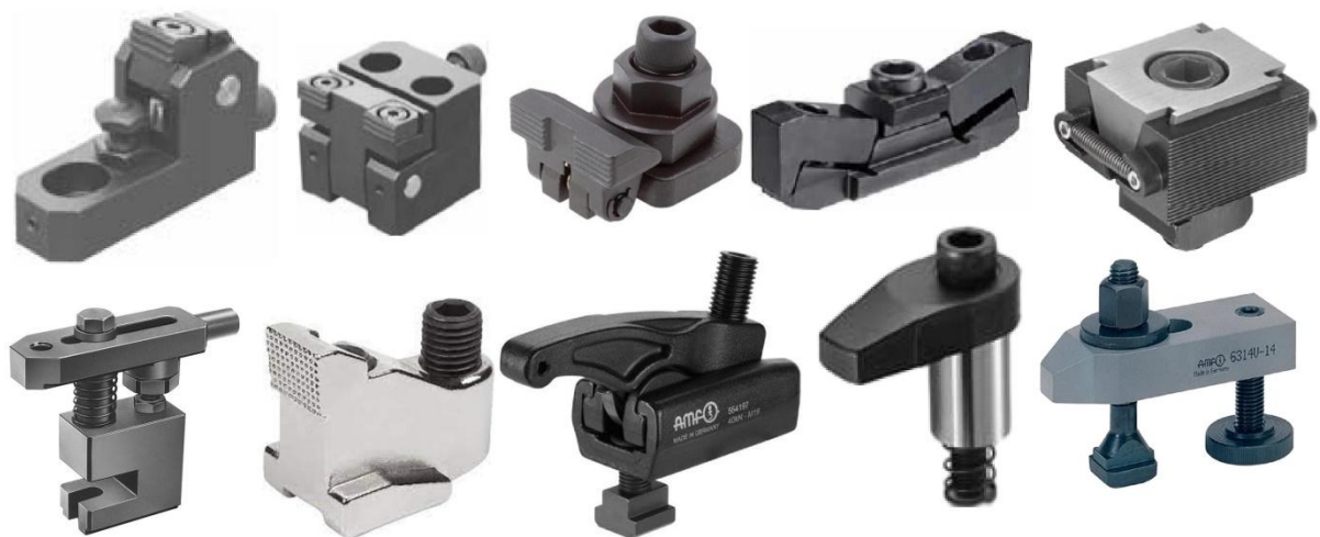
Рис. 4.4. Примеры конструкций модульных зажимных элементов
