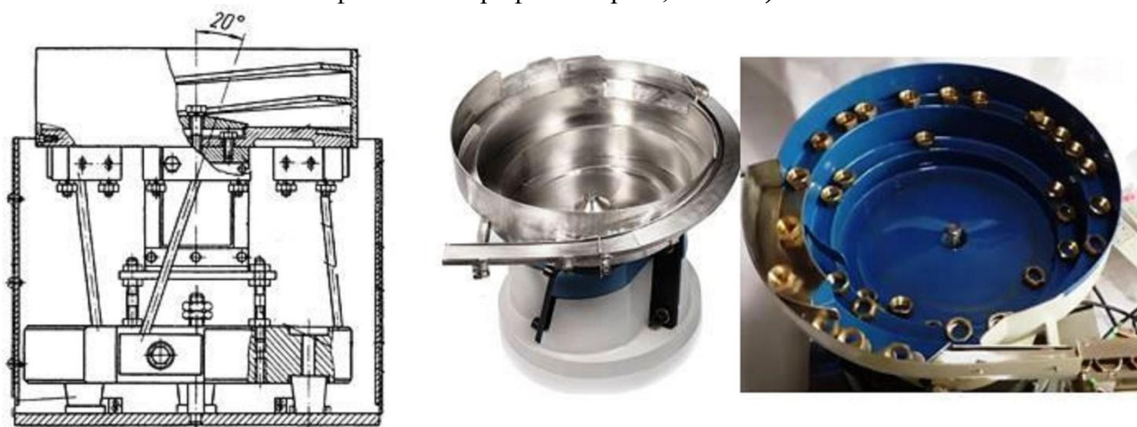
Рис. 5.8. Вибрационные бункера (применяют для подачи деталей самой разнообразной конфигурации (шайбы, гайки, винты, радиодетали и т.д.) и из различного материала (сталь, чугун, медь, текстолит, стекло и т.д.)
