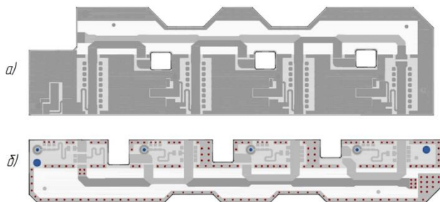
Рис. 13. Макетные печатные платы: а) печатная плата сумматора, б) печатная плата делителя.
