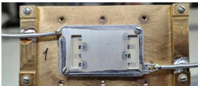
Рис. 12. Макет фильтра, установленный в технологическую оснастку для проверки электрических параметров.
