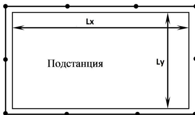
Рис. 11. Предварительная схема заземления подстанции
