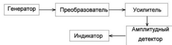
Рис. 5. Структурная схема прибора контроля, основанная на измерении амплитуды напряжения
