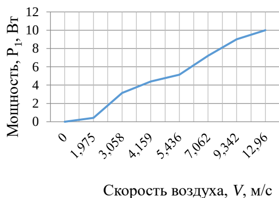
Рис. 5. График зависимости выходной мощности генератора от потока воздуха в электроэнергетическом агрегате
