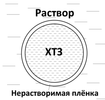
Рис. 2 Структурная модель капсулированного нерастворимой плёнкой хитозана
