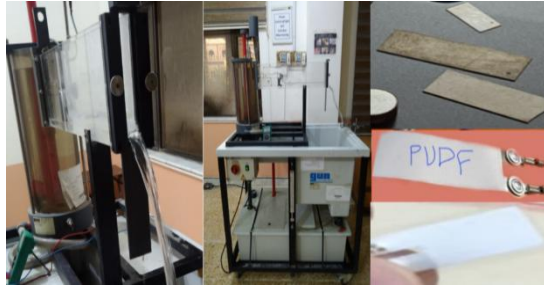
Рис. 5. Пьезоэлектрический материал и устройство, используемое в исследовании
