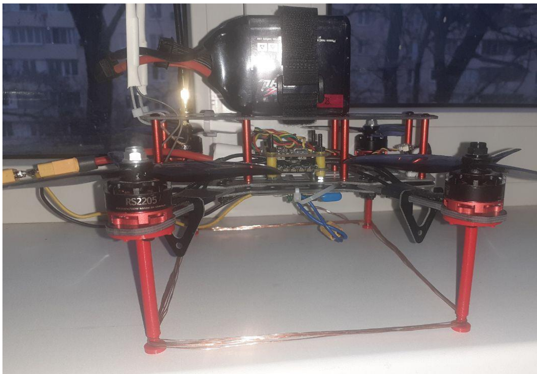
Рис.13 – Квадрокоптер с установленной приемной частью системы беспроводной зарядки
