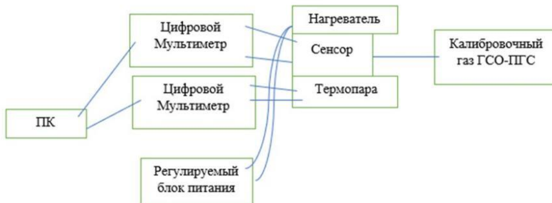
Рис.6 – Принципиальная схема для испытаний
