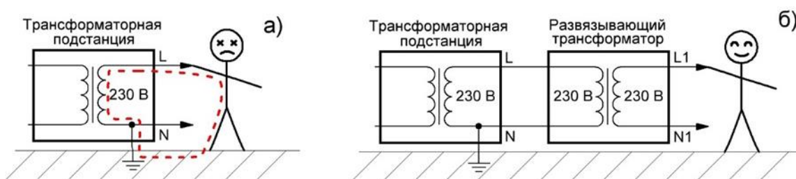
Рис.14 – Взаимодействие человека с сетевым напряжением: а) опасное; б) «безопасное»
