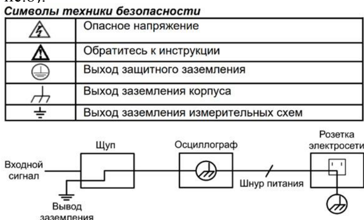
Рис.8 – Схема заземления осциллографа из документации
