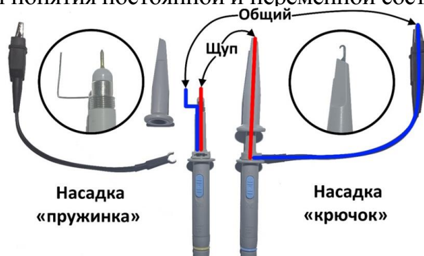
Рис.3 – Щуп осциллографа с насадкой: «пружинка» и «крючок» соответственно
