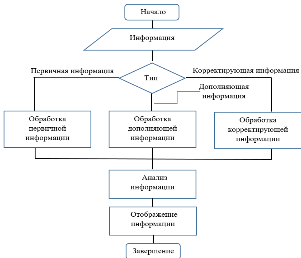
Рис.2 – Алгоритм управления потоком информации в зависимости от ее типа
