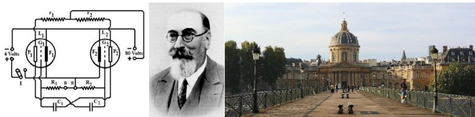
Рис. 16. Принципиальная схема мультивибратора, представленная Абрахамом и Блохом на заседании Французской академии наук 26 мая 1919 г. Эжен Блох. Справа — Институт Франции в Париже, где размещается академия.
