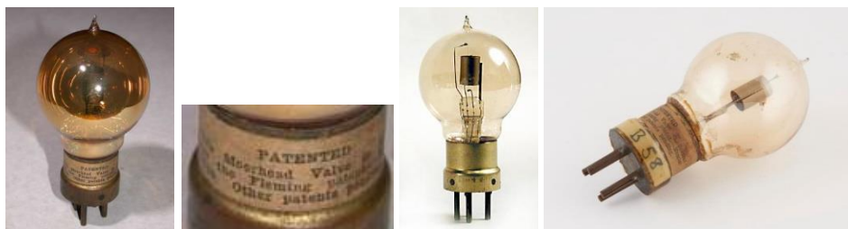
Рис. 11. Радиолампа типа «R» американской компании Moorhead . 1918 г.
