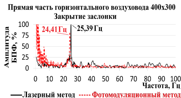
Рис. 5. Частотный анализ колебаний центрального пролёта воздуховода при закрытии воздушной заслонки
