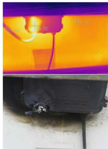
Рис. 2. Инфракрасная термография и результат перегрева СП
