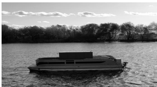
Рис. 5. Универсальный функциональный модуль морской энергетической установки на водородном топливе
