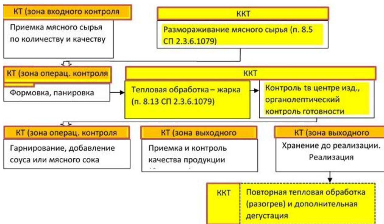
Рисунок 8.6 – Блок-схема производства кулинарных изделий (котлет)
