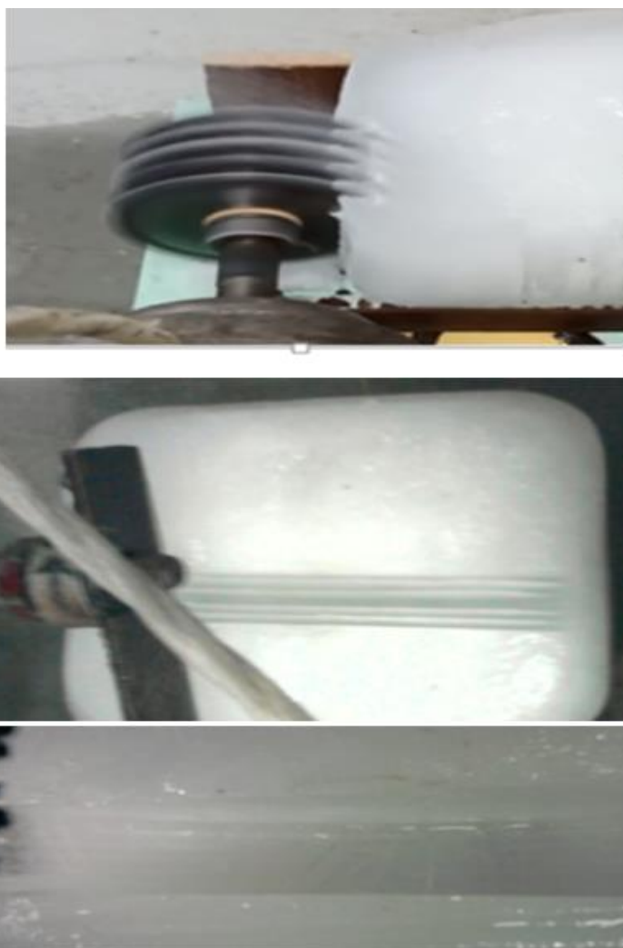
Рисунок 2 – Испытания для определения оптимального расстояния между режущими дисками при отсутствии нагрева
