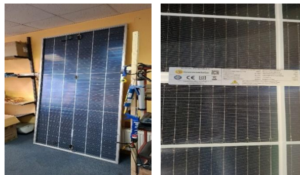
Рис. 1. Внешний вид фотоэлектрической панели для судовой энергетической установки (мощность модуля 730 Вт)
