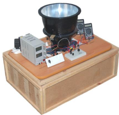
Рис. 9. Экспериментальная установка для снятия характеристик ФЭП
