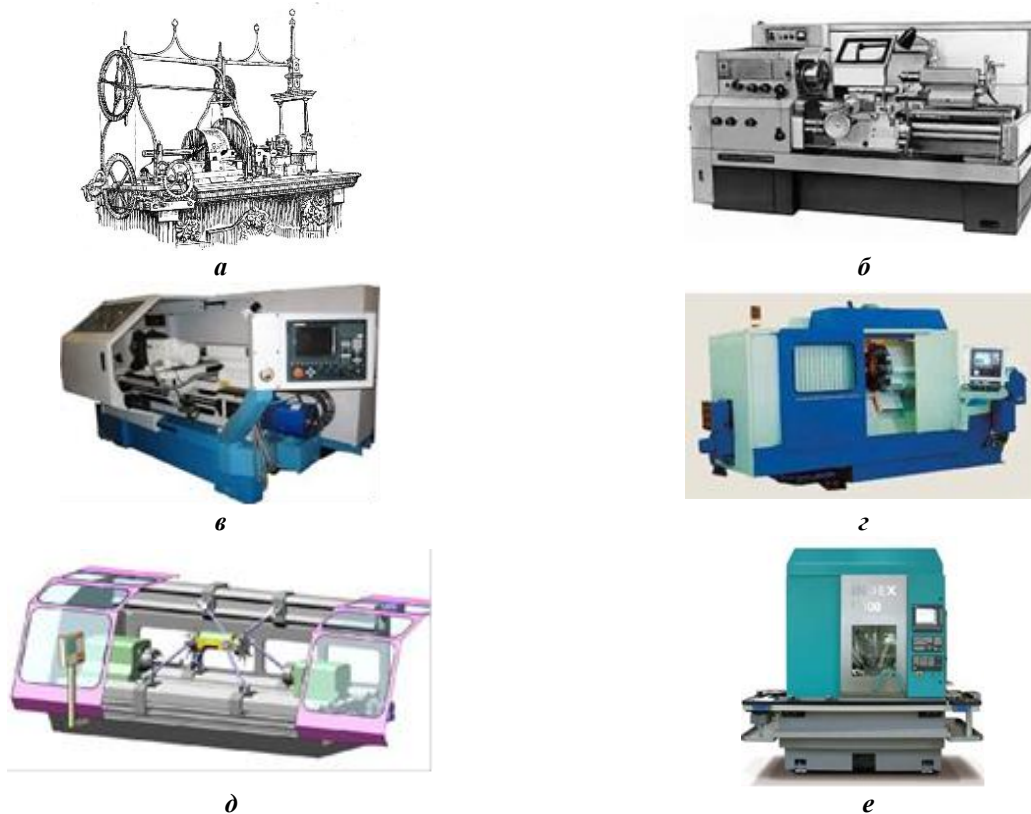
Рисунок 2. Уровни изобретений на примере развития металлорежущего токарного станка: а – первый в мире токарно-копировальный станок Андрея Нартова (1718 г.); б – токарно-винторезный станок 16К20 (1973 г.); в – токарный станок с ЧПУ 16К20Ф30 (1980 г.); г – многооперационный токарный центр 1П420ПФ40 (1990 г.); д – токарный многоцелевой станок на базе механизмов параллельной структуры (2006 г.); е – станок VerticalLine V100 (Германия) на основе дельта-робота (2015 г.)
